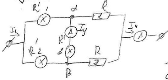
$I_1 = I_4$  ток входящий равен току выходящему
